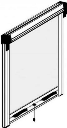
Pose dans le tableau de la fenêtre (retour de maçonnerie)
